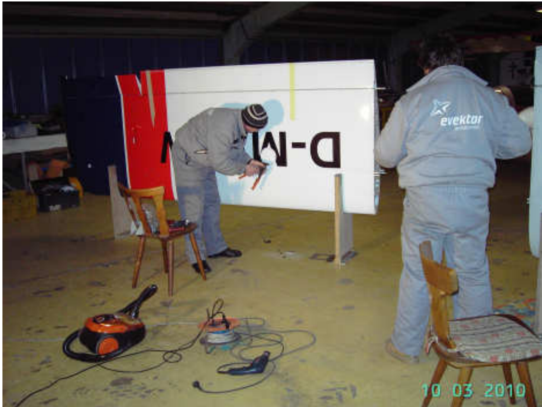
Verschließen der Prüföffnungen
